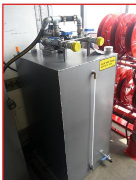
Bakım sırasında, iş makinaları, hafriyat araçları vb. makinalardan çıkan atık yağların havalı yada elektrikli pompalarla toplanması için uygulanan sistemdir. Bakım aracı durumuna göre atık yağ tankı kapasitesi belirlenmektedir. Müşteri taleplerine göre tank yerine atık yağ varili veya lbc tankları da kullanılabilmektedir. Yasal yükümlülüğe göre atık yağların toplanması zorunludur.
