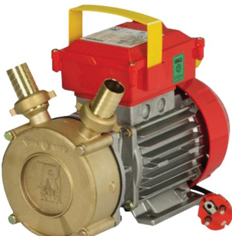
Kendinden emişli klasik pompalar geniş bir kullanım alanına sahiptir. Motor çift yönlüdür dönüş yönü sağ ve sol olarak çalıştırılabilir, pompa ve motor kısmının kompakt olması sayesinde taşınması kolaydır. Kullanabileceğiniz başlıca sıvılar şarap, şıra, tuzlu su, içme suyu, süt, yağ, gaz yağıdır.
